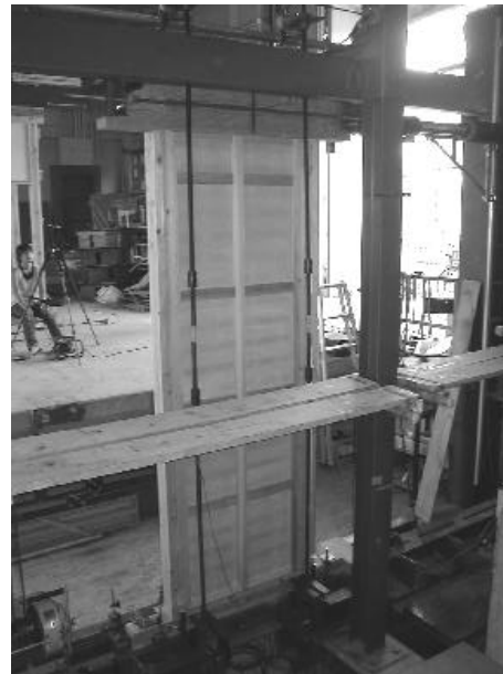
写真 6 1P 試験体設置状況
