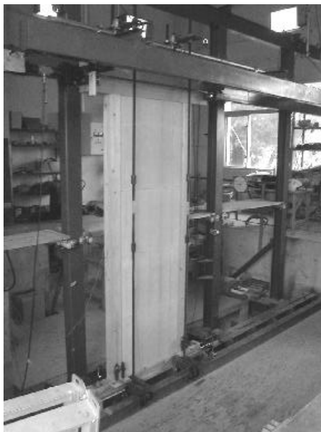
写真 5 1P 試験体設置状況
